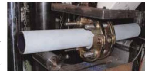
Versuchsanordnung Dreipunkt-Biegeversuch an zwei zusammengeflanschten Rohrenden DN 50
